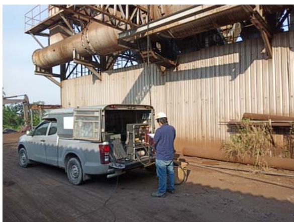
ภาพที่ 3.5.1 ภาพแสดงการเก็บตัวอย่างคุณภาพอากาศจากปล่องระบายอากาศ
